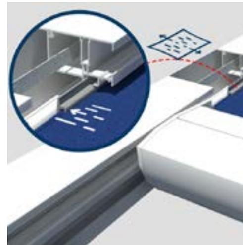
Durch die kontinuierliche Spannung der Zip-Screen-Technologie wird die Plane sicher in den Schienen gehalten.
